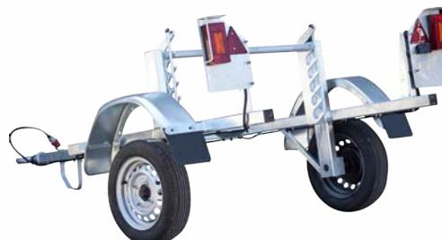
Châssis en tube mécano soudé. Avec suspension.
